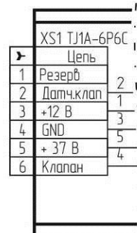
б) с разъемом TJ1A-6P6C
