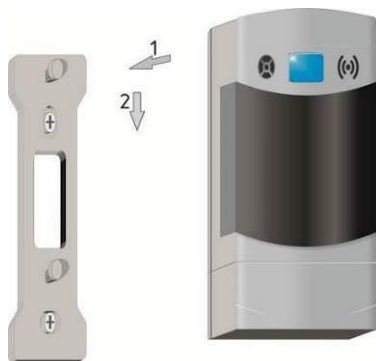
Рисунок 5 – Установка сигнализатора на монтажную панель
