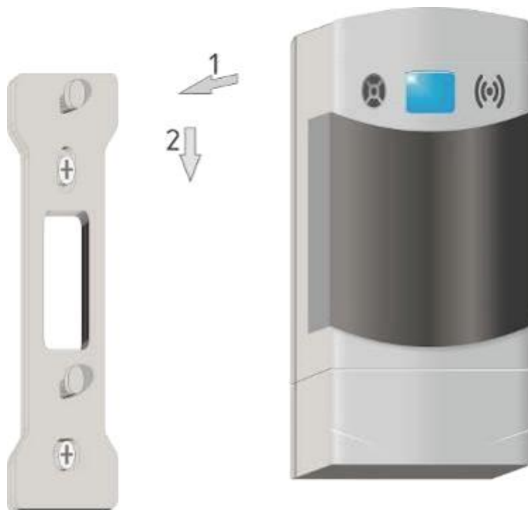
Рисунок Д.3 – Установка сигнализатора на монтажную панель
